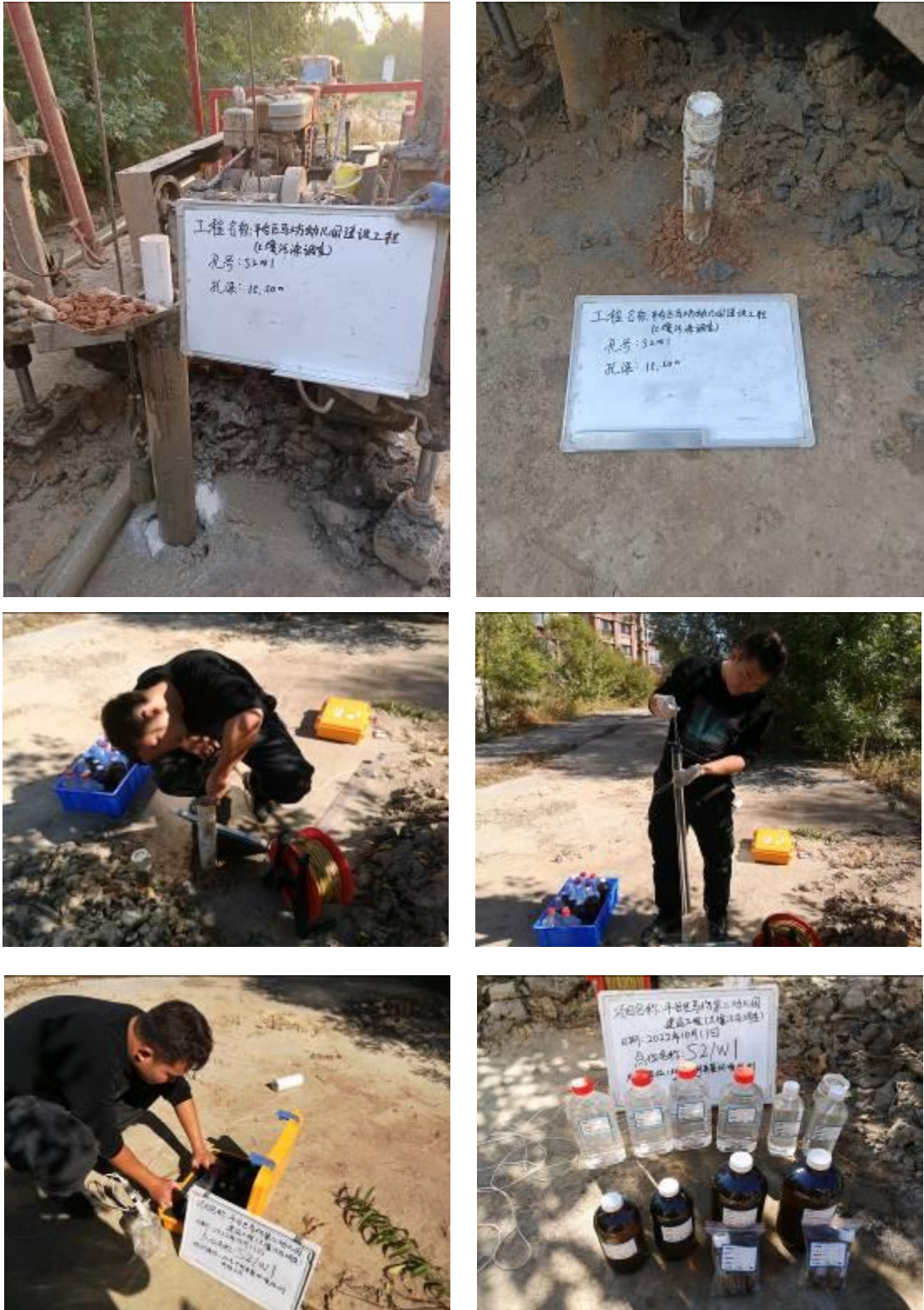
图 4.2-3 监测井成井及地下水现场取样照片
