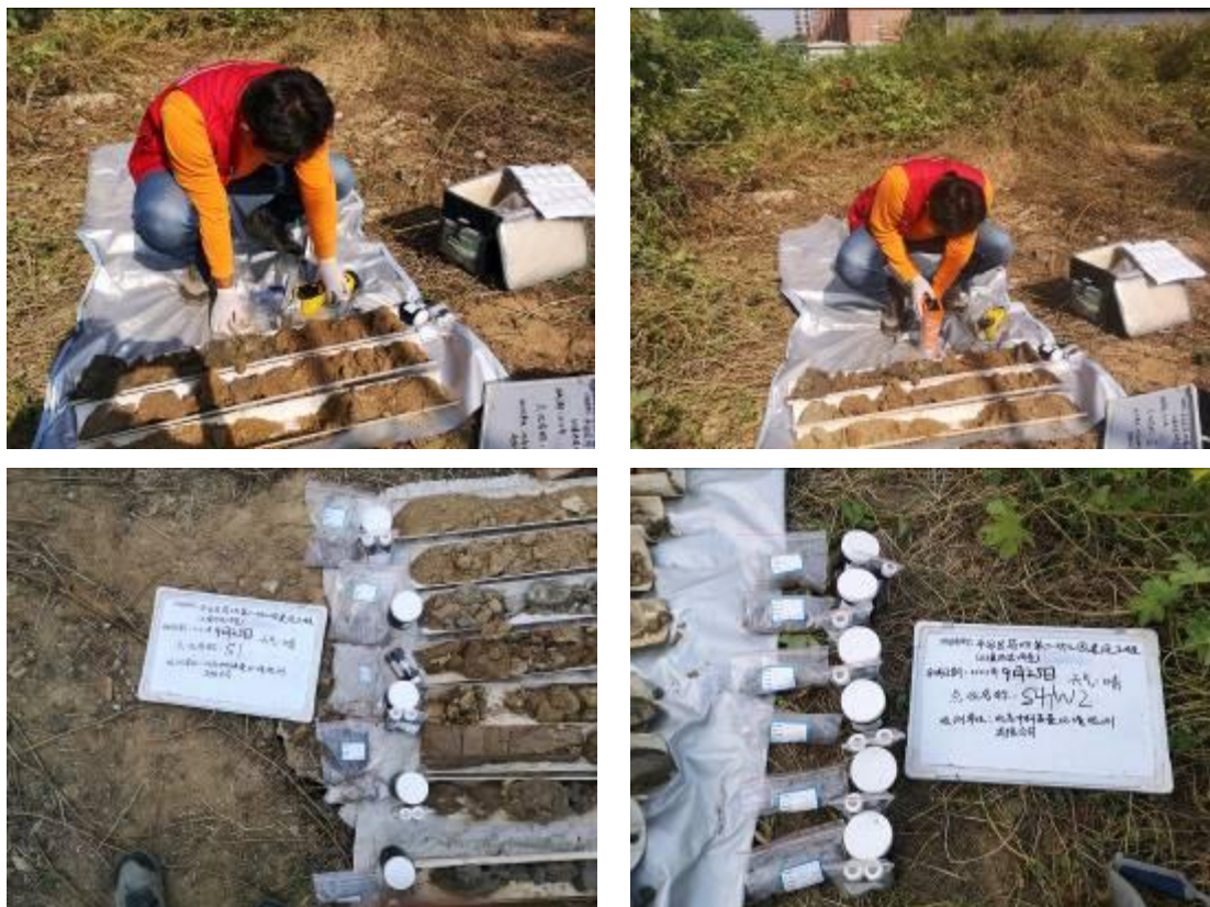
图 4.2-2 快筛检测和土壤样品照片
