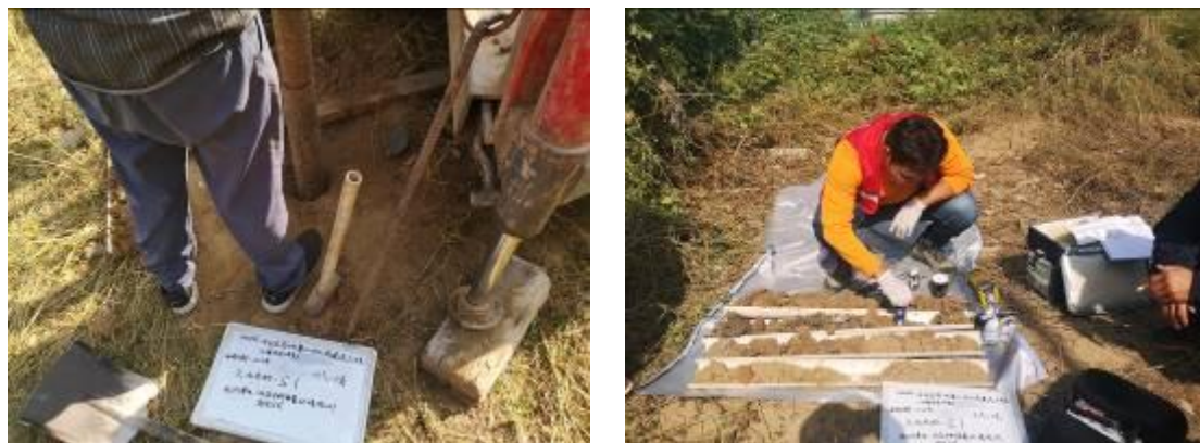
图 4.2-1 钻探过程及岩芯照片
